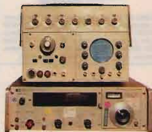
Sopra: TEST-SET 0 ÷ 500 MHz generatore di segnali digitale, con monitor per ricezione, ottimo per tutti i transceiver agenti da 0 ÷ 500 MHz. Sotto: FREQUENZIMETRO HP 52452 - Fino a 500 MHz, opz. 18 GHz.
